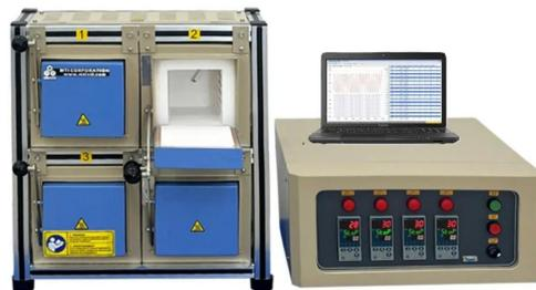
KSL-1100X-S-MGI-4 是一种小型型 4 室 (100\*100\*100mm) 箱式炉, 带有单独的 4 通道可编程温度控制器。此款设备适用于高通量实验对样品加热处理, 最高温度可达 1100°C。4 室炉可以放在标准手套箱中, 在惰性气氛下处理样品
