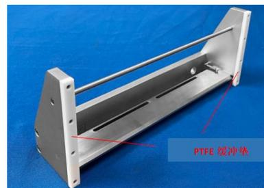
HDS-300D 是一款混合制膜器，可用于刮刀式涂布（流延涂布）制备后膜，挤压式涂布（slot die）制备薄膜。此产品是一款非常好的实验室制膜设备，可用于制作电池极片，钙钛矿太阳能电池薄膜和燃料电池膜等。
