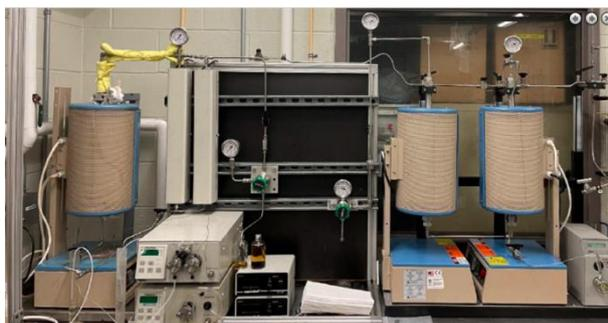
GSL-1100X-NV 是一款立式炉（不含炉管），用于 DIY 管式反应器（最大外径 50mm），最高工作温度 1100℃
