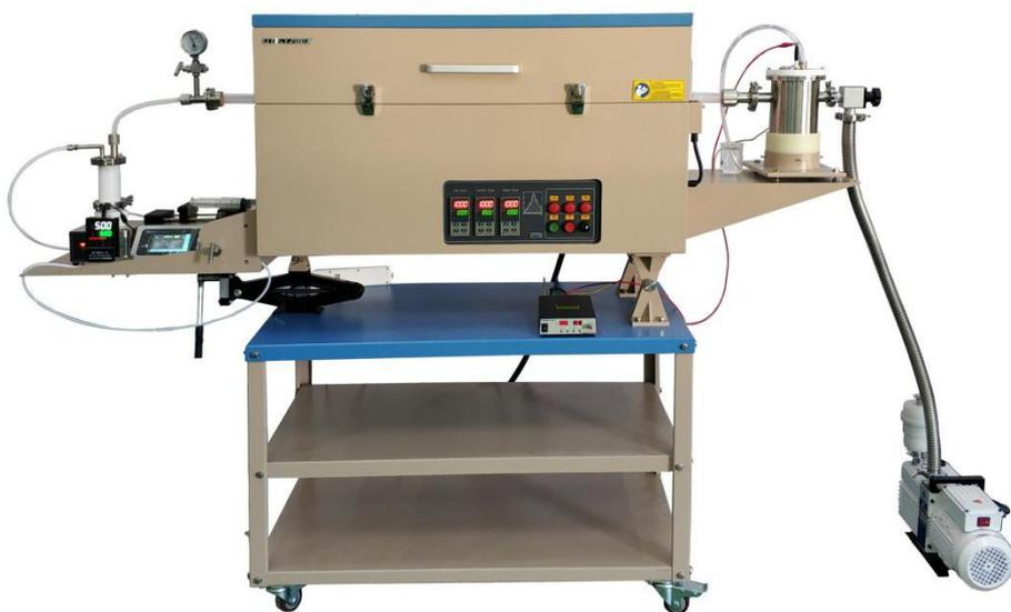
OTF-1200X-PGEP 是一款多功能的合成系统，针对于合成各种纳米结构氧化物以及纳米材料的复合包覆工艺，此款仪器有三个组成模块，超声雾化装置，1200 度管式炉和高压静电收集装置。材料制作分为三个步骤：前驱体雾化，加热和纳米颗粒收集。此款系统是一款非常先进的合成系统，可广泛用于纳米材料制备，电极材料包覆复合等方面。
