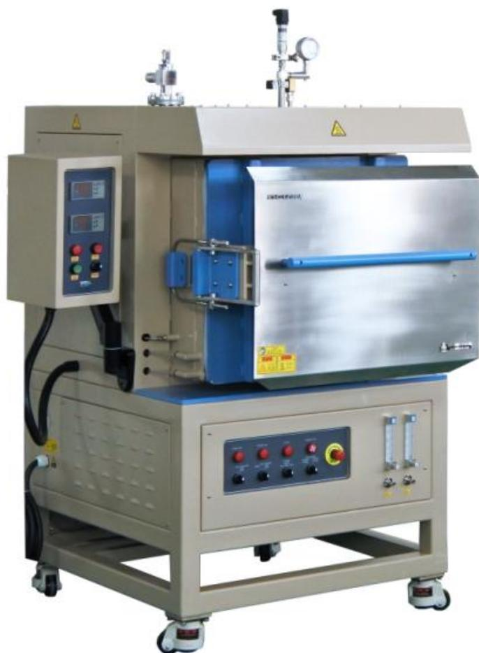
KSL-1200X-AC-5S 是一款 5 面加热的气氛箱式炉，设计用于在惰性气氛或纯 O<sub>2</sub> 环境下对材料进行热处理，因为炉膛 5 面都有加热元件，所以与传统箱式炉比较，其炉膛内部温场更加均匀。此款箱式炉采用高纯氧化铝作为炉膛材料，Kathal Fe-Cr-Al 合金丝作为加热元件，炉膛容积为 64L，炉膛在一个真空腔体内部，可在气氛保护环境下对样品热处理。
