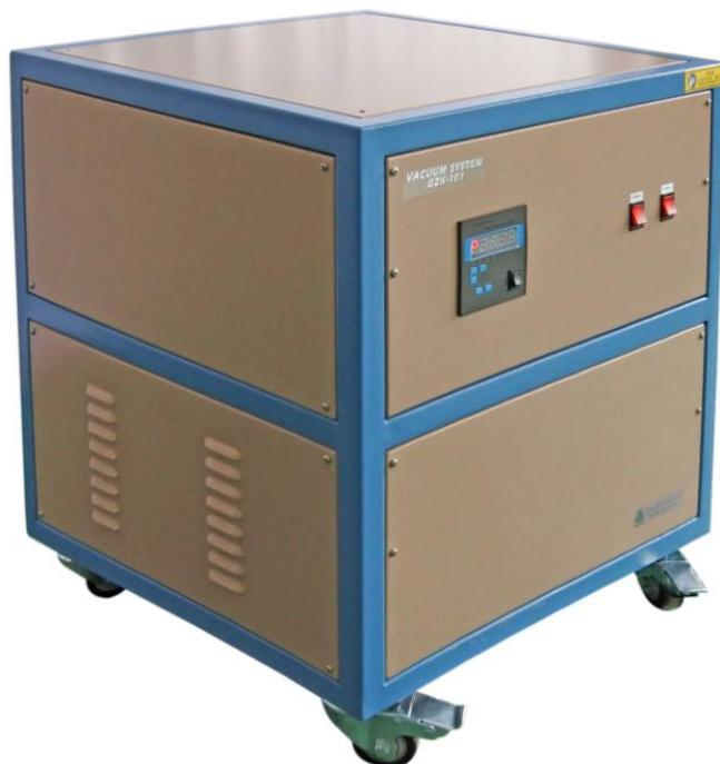
GZK-101 是一套低真空机组，其极限真空度为  $10^{-3}$  torr。内部安装有双旋机械泵 TRP-12 配套使用，其接口为 KF25 接口，含有电阻真空计 DGR-52 和连接管道接头等。
